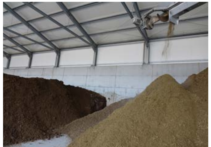
Lo stoccaggio del digestato. In alto a destra la tramoggia finale del separatore
