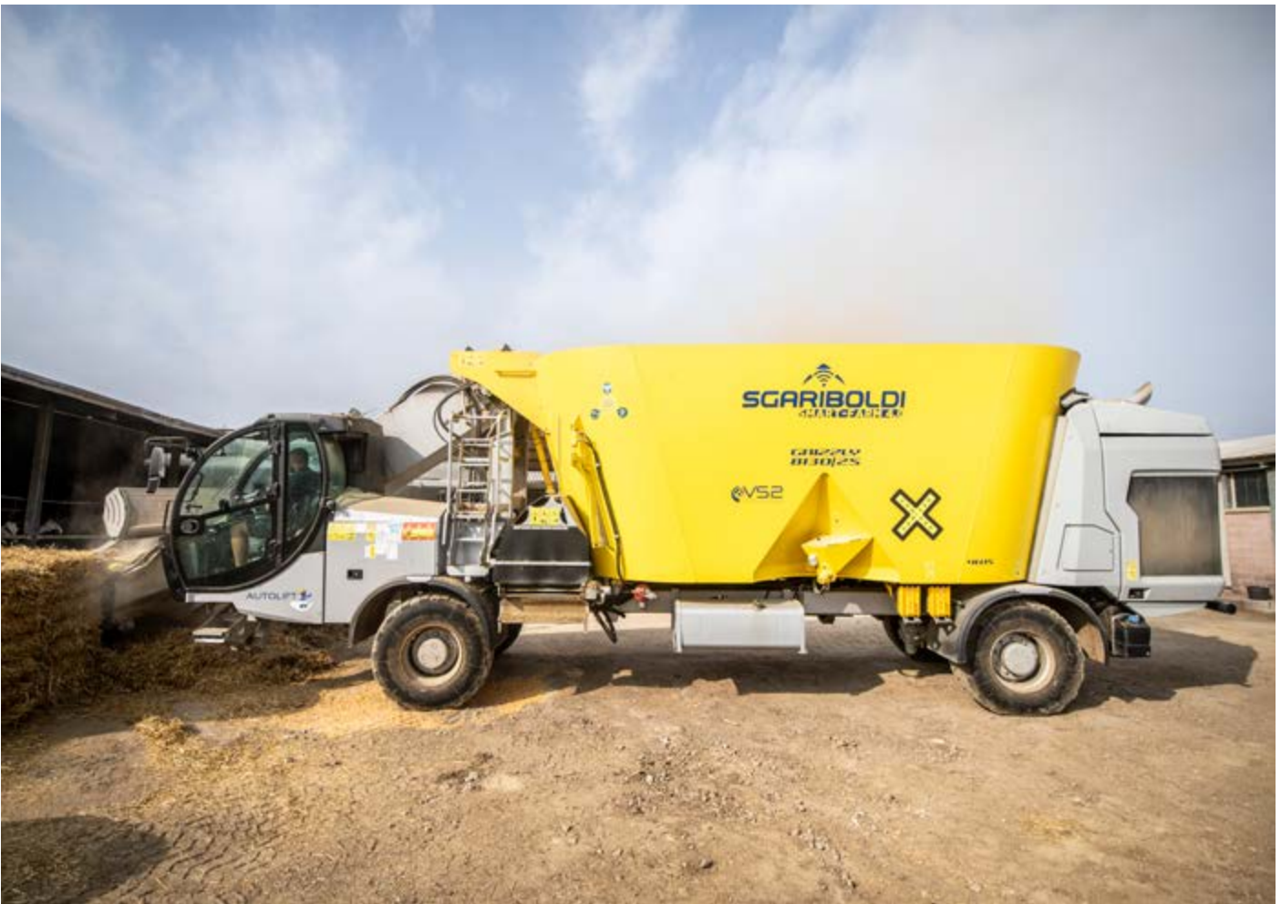
Il carro miscelatore adottato dall'azienda Gomiero, il Grizzly 8130 S della Sgariboldi, è dotato di I-Cab II, cabina di ultima generazione, e del sistema Intellitechnology
