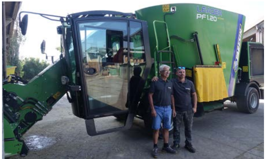
Ferdinando e Matteo Mapelli accanto al proprio carro miscelatore Leader PF 1.20 Ecomix della Faresin. Nel nome del modello, la cifra "1" indica il numero delle coclee, la cifra "20" indica i metri cubi di capacità della vasca
