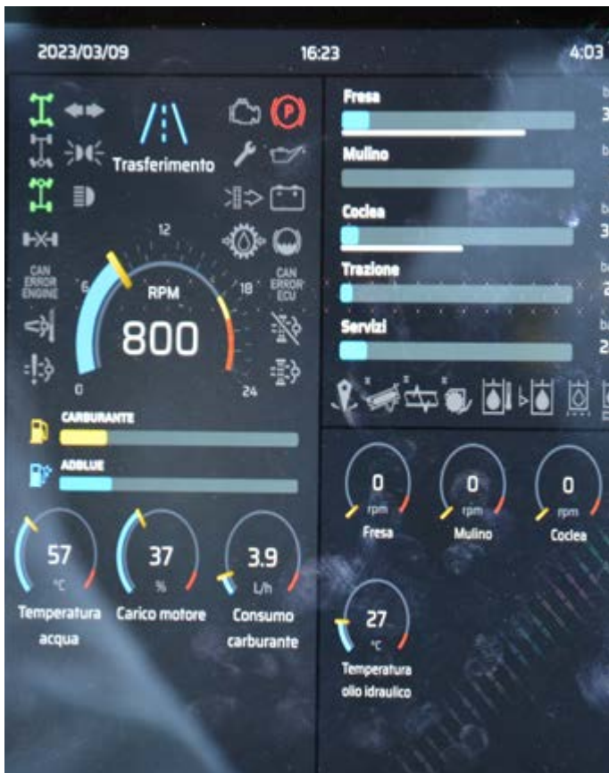
Il display da 10 pollici, con telecamera integrata, presente all'interno della cabina Renesis II.
