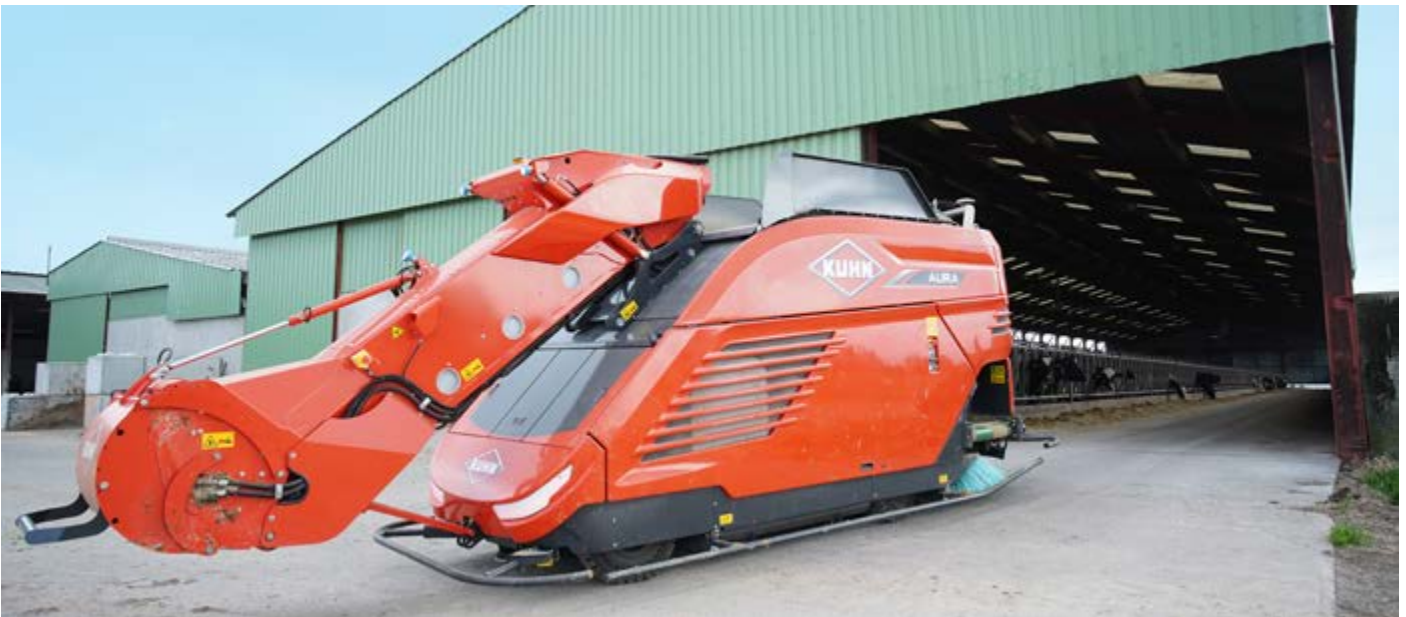
La macchina mentre entra in stalla per la distribuzione dell'unifeed agli animali. La vasca di miscelazione ha una cubatura di 3 mc ed è dotata di due coclee verticali.
