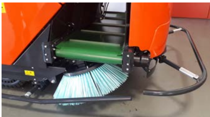
Il sistema di sicurezza di Aura include "bordi sensibili" attorno alla macchina per garantire che questa possa muoversi senza inconvenienti nel suo ambiente di lavoro.
