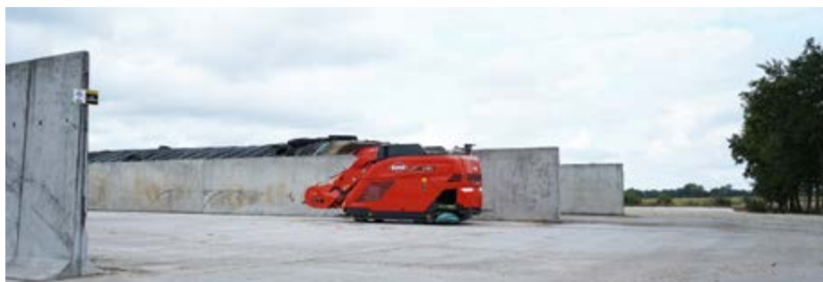
Azienda Gaec Cordiere, Vandea. Il carro miscelatore Aura mentre si sposta da solo da una trincea all'altra.
