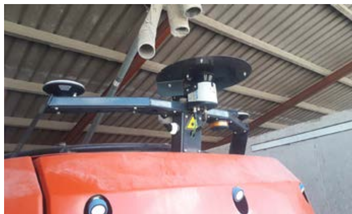
In evidenza, in entrambe le foto, i dispositivi riceventi ed emittenti che permettono al carro di muoversi da solo tra i vari edifici dell'allevamento con la precisione di un centimetro. Nella parte inferiore della seconda foto si notano anche tre sensori di movimento.
