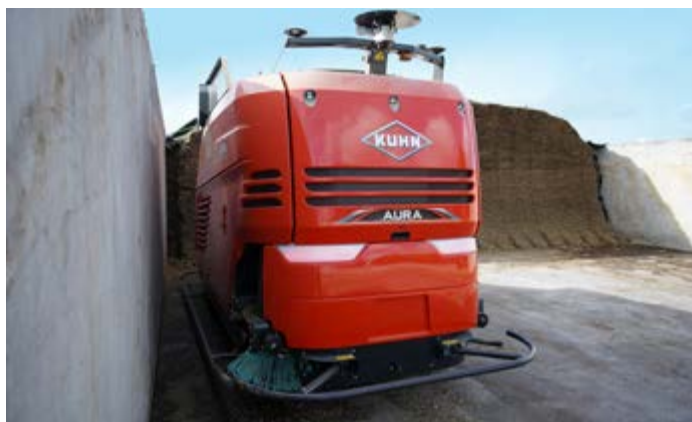
In evidenza, in entrambe le foto, i dispositivi riceventi ed emittenti che permettono al carro di muoversi da solo tra i vari edifici dell'allevamento con la precisione di un centimetro. Nella parte inferiore della seconda foto si notano anche tre sensori di movimento.
