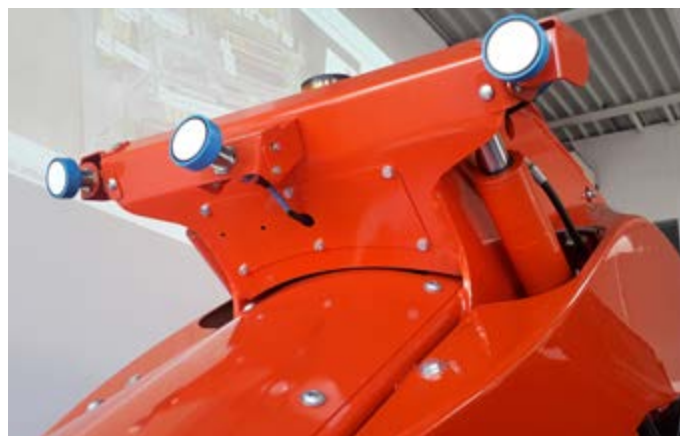
Tre sensori di movimento anche nella parte anteriore della macchina
