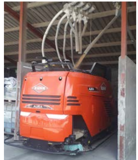
È automatizzato anche il carico delle farine nella vasca del carro miscelatore
