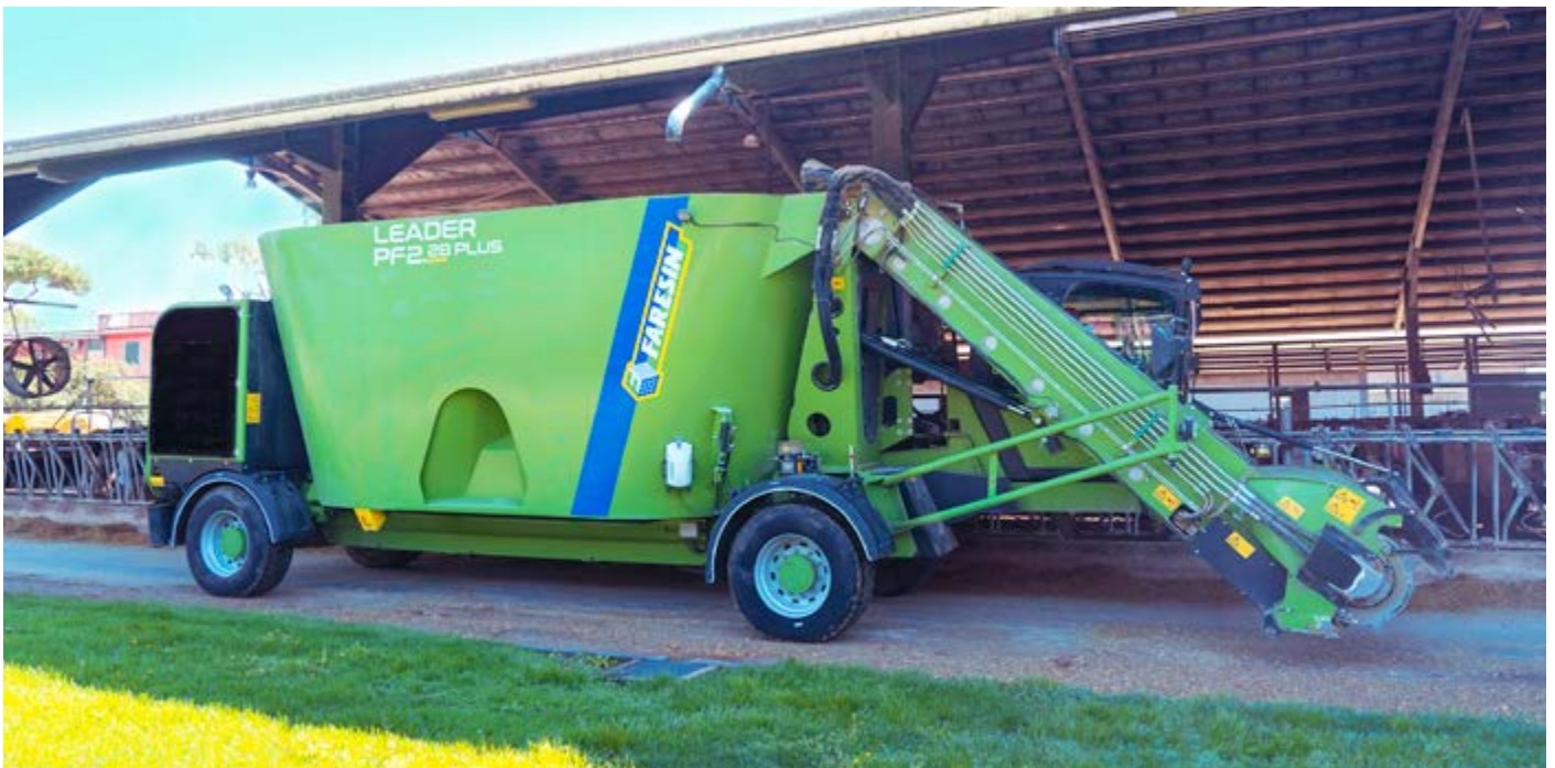
La gestione di un'alimentazione di precisione è possibile grazie a una particolare dotazione informatica del carro: il "Farm Manager Web", che mette in comunicazione la pesa del carro unifeed con il computer aziendale.
