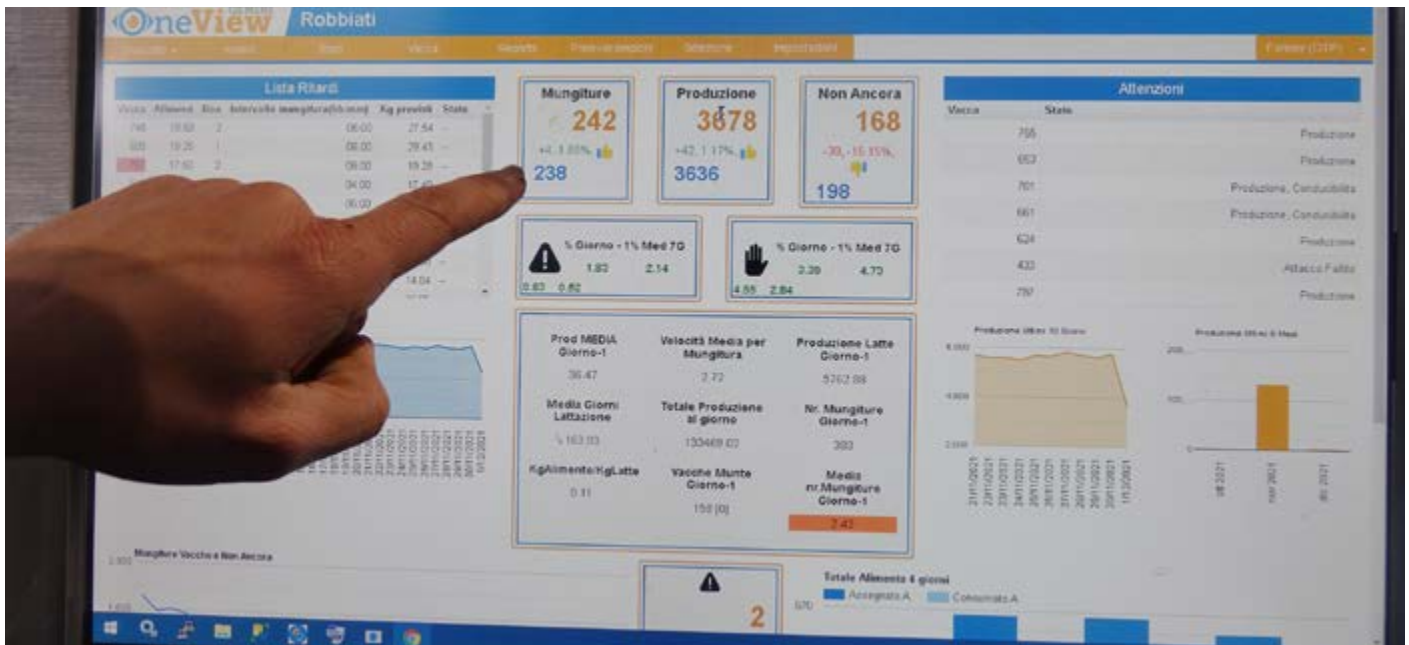
Fra le dotazioni dei robot Gemini Boumatic c'è il software OneView. E tra le varie informazioni che quest'ultimo fornisce all'allevatore c'è quella dell'andamento dell'operazione di mungitura, vacca per vacca
