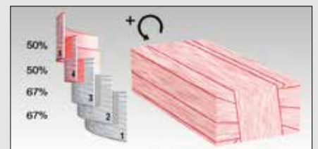
2 strati finali con il 50% di sovrapposizione
