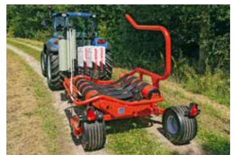
Larghezza di trasporto limitata grazie alla posizione regolabile delle ruote
