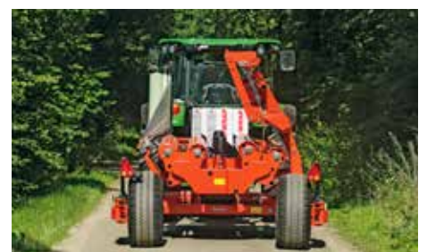
Per il trasporto su strada, le ruote possono essere ripiegate all'interno per ridurre la larghezza di trasporto. Il ripiegamento idraulico è disponibile su richiesta
