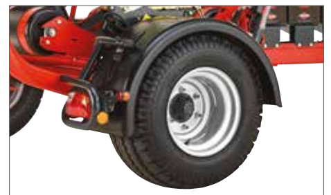
I parafranghi larghi prevengono il danneggiamento della pellicola durante il trasporto
