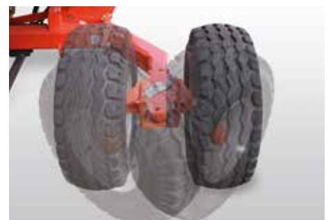
La ruota destra può essere ripiegata verso l'interno per il trasporto su strada. La ruota sinistra su richiesta
