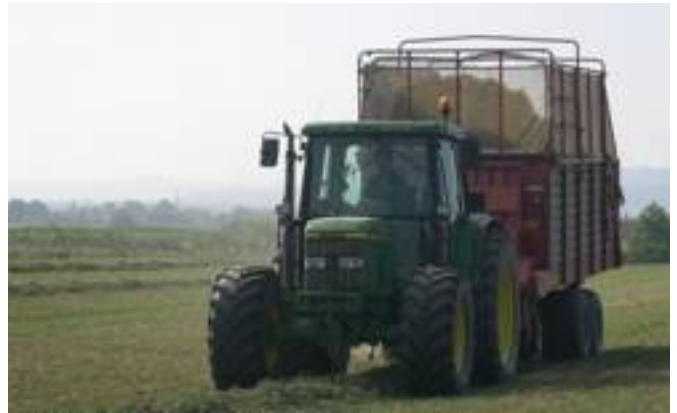
● Un carro autocaricante. Nel futuro è impensabile l'utilizzo di macchine per la foraggicoltura che siano energivore. Anzi, il Crpa auspica la possibilità di arrivare ad utilizzare motori ibridi, diesel ed elettrici.
