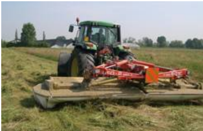
● Consentendo un'evaporazione dell'acqua uniforme tra stelo e foglia, la falciaccondizionatrice fa sì che si riducano i tempi di essiccazione del foraggio.
