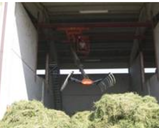
● Sopra, un caricatore a griffe per l'essiccazione artificiale.
