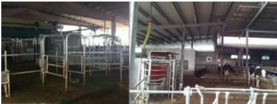
● Figura 3 - Il robot deve essere visibile e facilmente accessibile alle bovine. Per non avere effetti negativi sull'handling time gli spazi antistanti il robot devono essere adeguati. A sinistra, Ams con traffico guidato degli animali; a destra, circolazione libera degli animali (Tangorra, 2013-2014).
