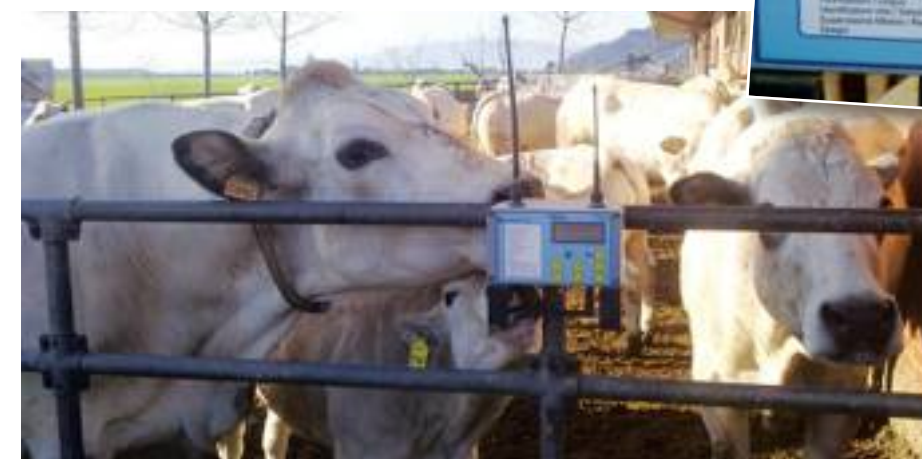
● Due immagini della centralina (base radio gsm). Questa invia un sms sia in caso di abbassamento naturale della temperatura dell'animale (parto "probabile" o "atteso" entro le 24/48 ore successive), sia in caso di espulsione del radio-termometro a seguito della rottura delle acque (parto imminente). Impostando un resoconto delle temperature alla mattina e alla sera, l'allevatore può organizzarsi per tempo e spostare in anticipo l'animale in sala parto, così da diminuirne il livello di stress.
