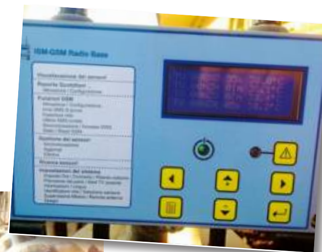
● Due immagini della centralina (base radio gsm). Questa invia un sms sia in caso di abbassamento naturale della temperatura dell'animale (parto "probabile" o "atteso" entro le 24/48 ore successive), sia in caso di espulsione del radio-termometro a seguito della rottura delle acque (parto imminente). Impostando un resoconto delle temperature alla mattina e alla sera, l'allevatore può organizzarsi per tempo e spostare in anticipo l'animale in sala parto, così da diminuirne il livello di stress.
