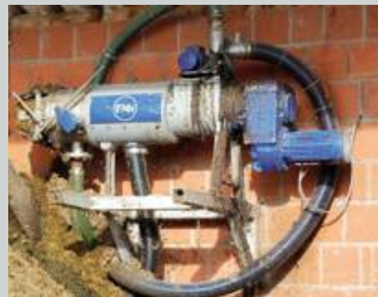
● Foto 3 - Attrezzatura di separazione liquido/solido a compressione elicoidale.
