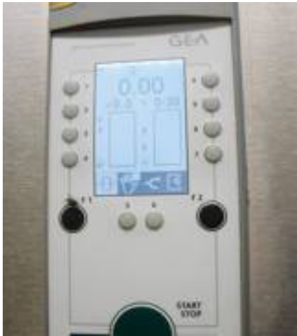
● Il display presente in corrispondenza di ciascuna delle 40 poste di mungitura. Mette in evidenza diversi dati, produttivi ma non solo, relativi alla singola bovina.
